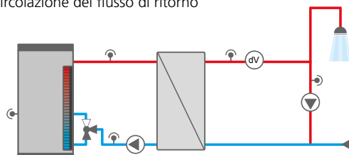
A CASCATA: Figura del sensore con stratificazione e circolazione del flusso di ritorno
